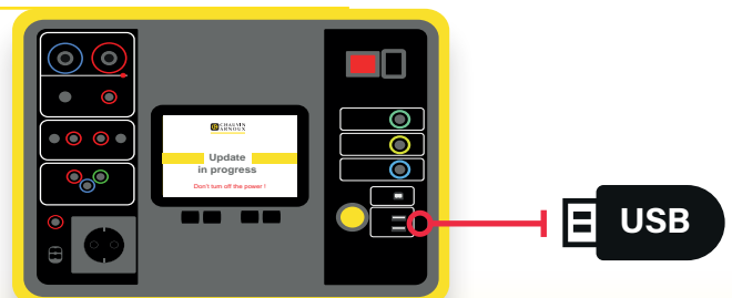
Actualización del firmware con una memoria USB
