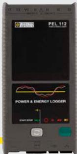
3 entradas de tensión, 3 entradas de corriente. **Compacto y magnético**, sin display, soporta **temperaturas bajo cero** y es apto para su uso en cámaras frigoríficas (**-20 °C**).
