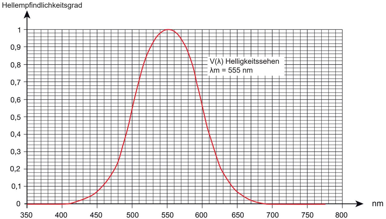
Als Maß für den Fehler in der Spektralempfindlichkeit des Fühlers gilt die Fläche zwischen der  $V(\lambda)$ -Kurve und der Fühlerkurve.
