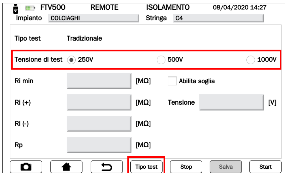
Figura 14.7.5-1 Schermata misura Isolamento
