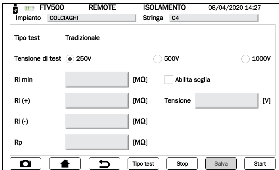
Figura 14.7.5-3 Schermata misura Isolamento
