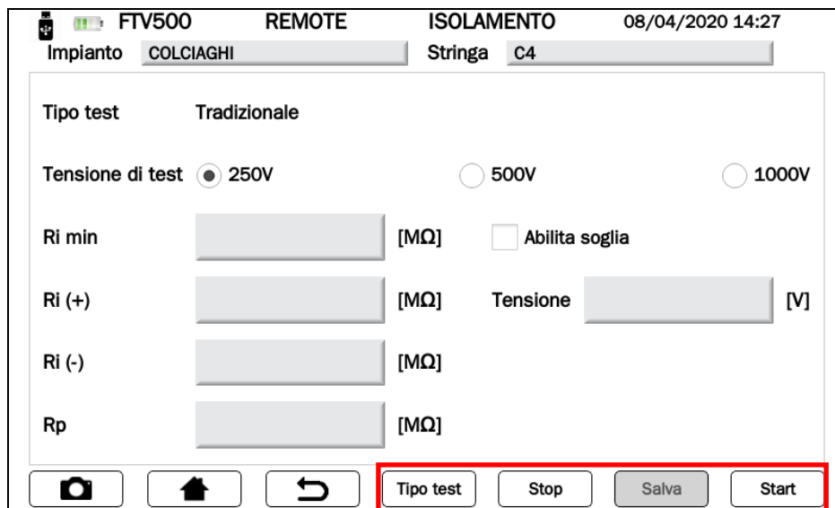
Figura 14.7.5-6 Schermata misura Start Isolamento
