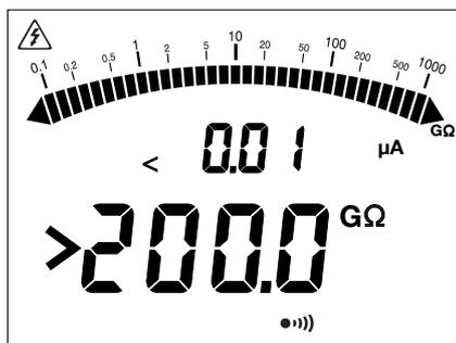
Pendant la mesure d'isolement, si la valeur à mesurer dépasse la gamme de mesure (qui dépend de l'appareil et de la tension d'essai), l'appareil le signale.
