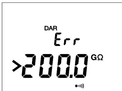
Pour le CA 6524 ou le CA 6526, si cela survient pendant une mesure de DAR ou de PI, l'appareil interrompt la mesure et affiche l'écran ci-contre.
