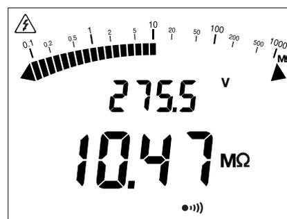
Le symbole ⚡ signale que l'appareil génère une tension dangereuse (> 70 V).
