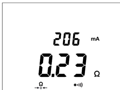
L'appareil effectue directement la mesure. Il affiche le résultat ainsi que le courant de mesure.
