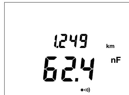
El instrumento indica el valor de la capacidad así como la longitud de línea correspondiente calculada a partir de la capacidad lineal programada.
