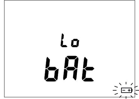
Es imprescindible entonces cambiar las pilas (véase § 5.2), al ya no ser fiable la indicación de la autonomía.
