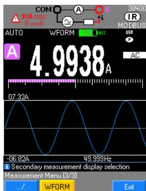
Durante la misura di corrente AC, è possibile visualizzare la forma d'onda dei segnali di frequenza 10 Hz a 600 Hz grazie alla funzione **wFORM**.
