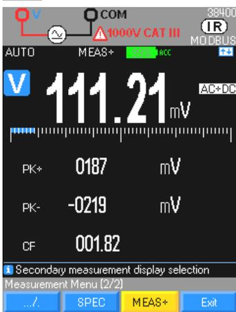
Se si vogliono fare misure di picco rapido per le seguenti funzioni di misura: V e A (AC, AC+DC), queste sono accessibili dalle misure secondarie: selezionare **MEAS**, **MEAS+**, **PK+** e **PK-**; tempo d'integrazione è sotto **250 µs**.
