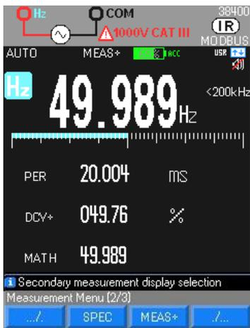
Visualizzazione della misura in % di un segnale logico (TTL, CMOS ...)
