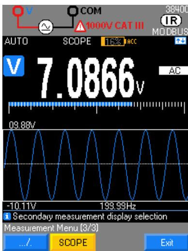
Durante la misura di tensione AC, è possibile visualizzare la forma d'onda dei segnali di frequenza 10 Hz a 600 Hz grazie alla funzione **wFORM**.
