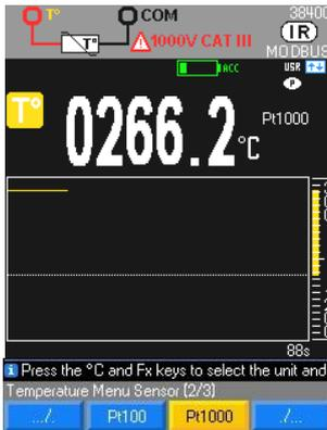
Misura della temperatura con un sensore: Pt100/Pt1000
