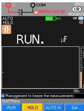
Misura della capacità di un condensatore con risoluzione di 1000 punti "Run" appare quando la misura è in corso.
