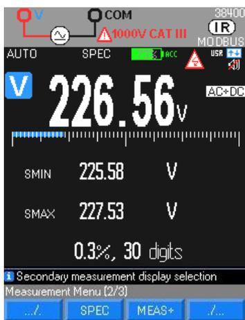
A partire dalle specifiche tecniche interne al multimetro, la modalità **SPEC** visualizza direttamente la tolleranza della misura in corso, senza necessità di cercarla e calcolarla.
