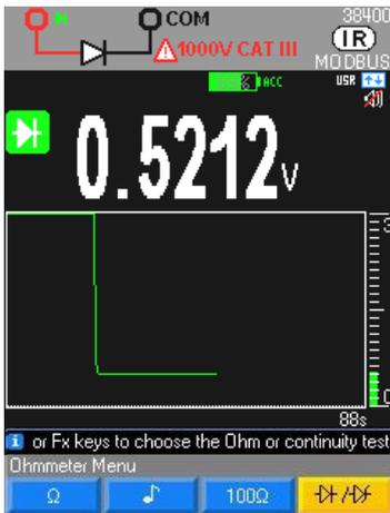
Letture del valore della tensione di soglia, se il circuito è aperto o la soglia del diodo >4V indicazione OL.
