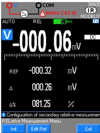
In modalità continua "DC", si misura il valore di una tensione continua o la componente continua di una tensione alternata.
